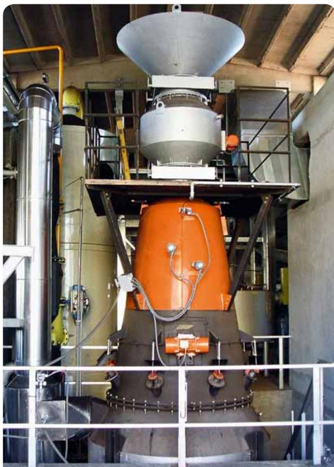
Gassificatore da 500 kWe alimentato con 5.000 t/anno di biomassa al 20% di umidità. Foto Caema
