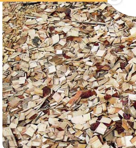
Il cippato proveniente dalla pulizia del bosco al 20% di umidità ha un potere calorifico di 3.520 kcal/kg
