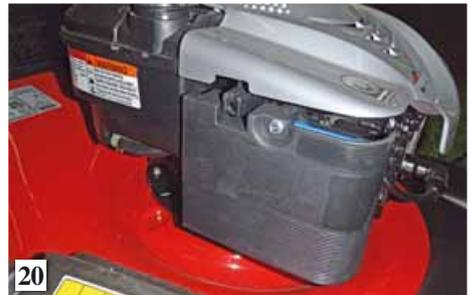
**Il controllo e la pulizia, o sostituzione, del filtro dell'aria.** Un filtro dell'aria intasato (15) non permette un'alimentazione corretta del motore. Filtro del tipo a cartuccia (16). Per accedere all'elemento filtrante occorre allentare la vite di fermo del coperchio del corpo filtrante (17). Pulitura con getto di aria compressa diretto dall'interno verso l'esterno (18). Riposizionamento dell'elemento filtrante (19) e chiusura del coperchio (20)
