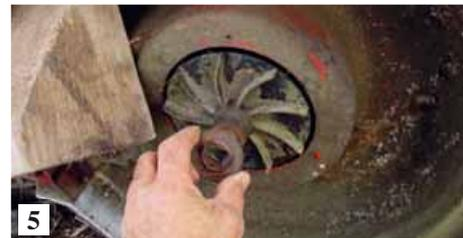
**Il controllo della lama.** Lama smussata e rovinata (1) e lama molto danneggiata (2) che vanno sostituite: si blocca la lama con una zeppa di legno (freccia) (3) e si svitano i bulloni con l'uso di una chiave adeguata (4). Va prestata attenzione alla sequenza di montaggio delle rondelle (5). Bisogna controllare che la lama non si sia piegata a seguito di urti violenti (6). Nel caso va sostituita con un ricambio originale (7)
