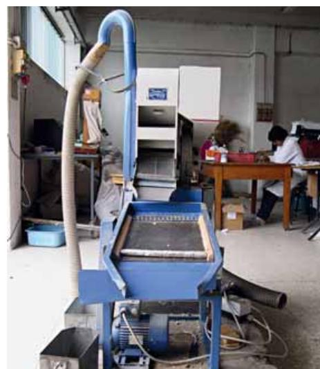
*La granella «vestita» si deve sottoporre a decorticatura (o sbramatura) con apposite attrezzature, per eliminare le glume e le glumelle che la ricoprono. Nelle foto, due diversi modelli di decorticatrici*
