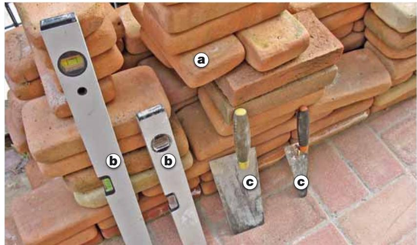
Per realizzare un metro di muretto largo 25 cm e alto circa 60 cm occorrono circa 72 mattoni pieni (dimensioni standard 5,5 x 12 x 24,5 cm) [a], livella [b] e cazzuola [c]. Vi servono inoltre malta bastarda, un secchio (per la malta), matita o polvere per tracciare il percorso del muretto
