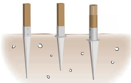
■ Staffe per il fissaggio al suolo della cornice del grigliato mediante interrimento
