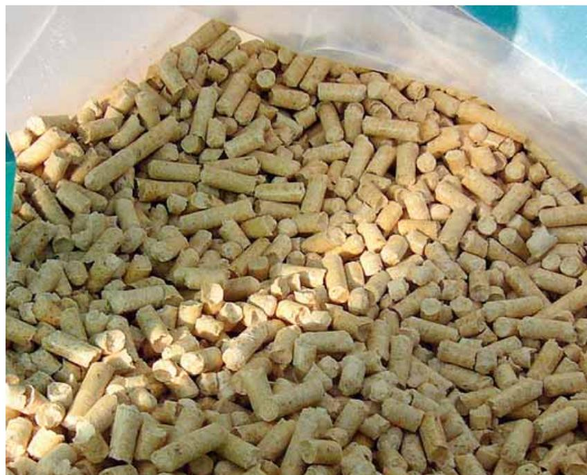
**Il pellet è un prodotto combustibile pressato, di forma cilindrica, ottenuto dalla compressione di legna sminuzzata. Deve essere prodotto da legno vergine, non contaminato da altri materiali di origine sintetica come colle, vernici, plastiche, derivati, preservanti, ecc. All'acquisto leggete l'etichetta**
