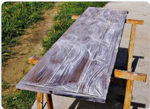
**1** Bisogna stendere con pennello, spugna o straccio sulle zone interessate una pasta ottenuta mescolando percarbonato di sodio in polvere e acqua. È bene procedere per prove: il percarbonato a contatto con l'acqua libera ossigeno, che aggredisce le zone scure sbiancandole. L'entità della decolorazione è proporzionale alla concentrazione di percarbonato e alla durata del contatto
