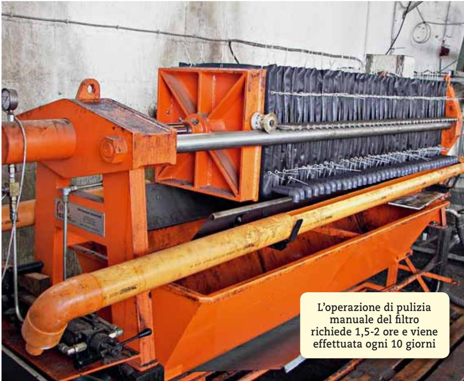
L'operazione di pulizia manuale del filtro richiede 1,5-2 ore e viene effettuata ogni 10 giorni
