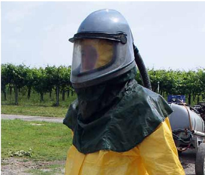
Foto 6 - Casco dotato di pettorale a mantellina
