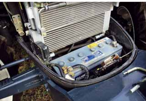
La batteria posizionata frontalmente è ben protetta e di facile accesso
